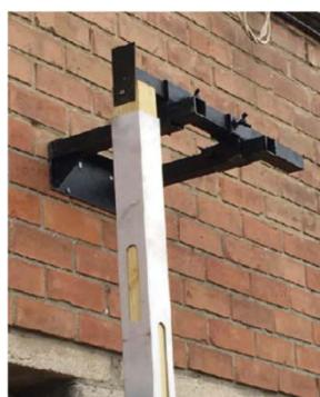
Les consoles porte guide permettent un gain de temps en réglant facilement et rapidement l'aplomb des rangs de briques. Réutilisable, elles se fixent sur une paroi et évitent toutes découpes de bois
