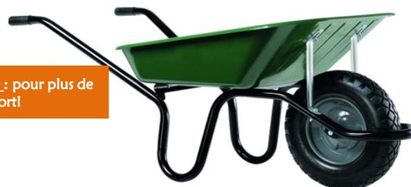
Caisse peinte 90L, épaisseur 0,9mm. Châssis CP2i (monobloc grande résistance, ergonomique et indéformable) avec support caisse. Jante métal. Charge utile 150kg. Brouette résistante, multi-usages, idéale pour tous les travaux lourds. Caisse nervurée à l'avant pour une meilleure rigidité.
