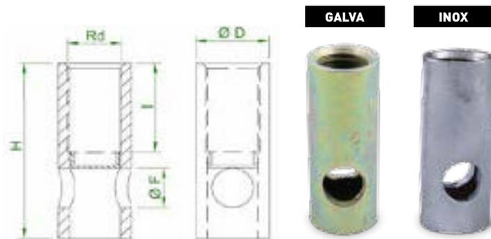
Les douilles de levage rondes à trous doivent être obligatoirement utilisées avec des armatures supplémentaires ainsi que des étriers de cisaillement en cas d'effort de levage supérieur à 15°.
