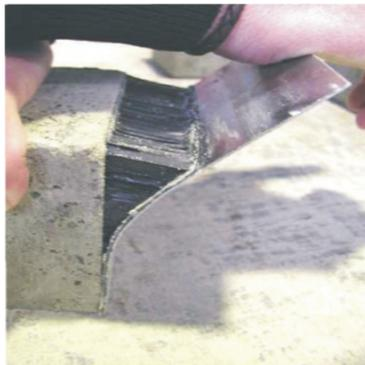
FRADIFLEX®: Produit idéal pour étanchéiser vos reprises de bétonnage.
