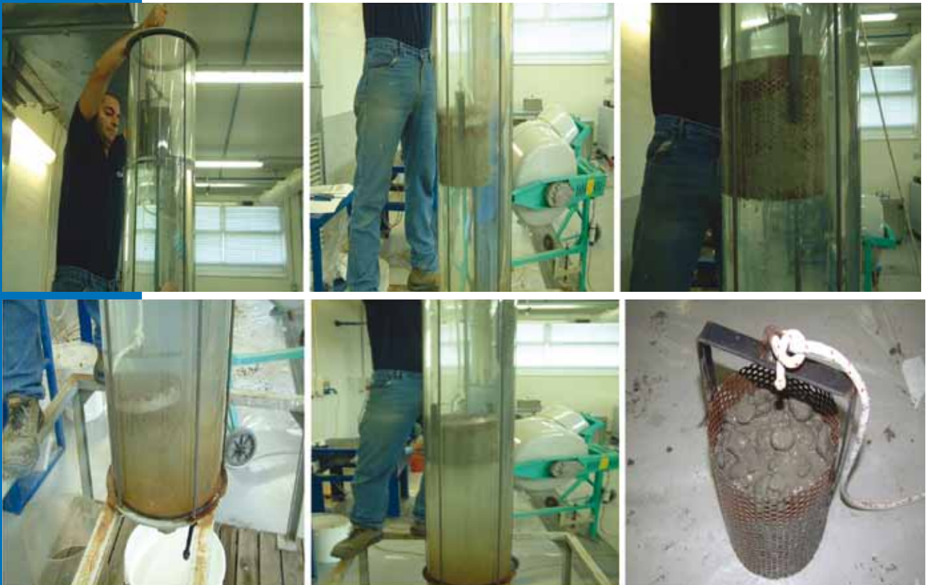
Vérification du délavage et aspect du béton au terme de l'essai
