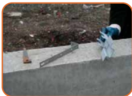
1. Trois éléments composent le COFRA'VIT
