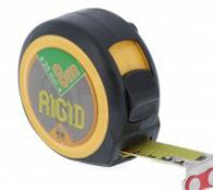
Boîtier co-moulé compact. Blocage avec tringle métal. Ruban 0,15 mm d'épaisseur : rigidité horizontale 2,40 m. Equerre aimantée. Le ruban sorti du boîtier repose bien sur le même plan que la mesure.
