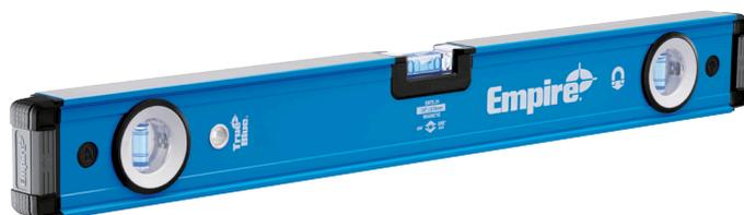
Bandes de contraste haute visibilité e-Band™. Fioles monobloc acryl à haute résistance contre les impacts et système d'ancrage de la bulle renforcée. Semelles usinées, précision 0.5 mm, cadre 40 % plus solide, grip de surface. Embouts de protection ultra résistants Bande magnétique puissante.
