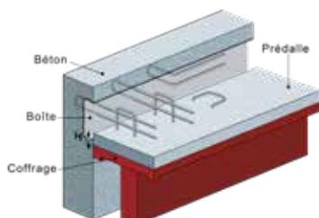
Déployer les aciers de l'AB-BOX prédalle en même temps que les suspentes aciers des prédalles. Déployer les aciers avec un tube de façon à ne pas créer de baionnette.
