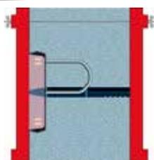
Disposer les AB-BOX prédalles sur les banches grâce aux aimants prévus pour s'emboîter dans les AB-BOX. les aciers doivent être disposés en partie supérieure. Appliquer également des entretoises en les enfonçant dans les opercules de la box et ainsi éviter toute entrée de béton dans la boîte en plaquant le capot contre le coffrage.
