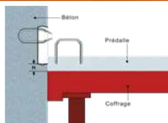
Après le décoffrage, mettre en place les prédalles suspendues puis retirer les couvercles en polypropylène. Respecter la cote H entre l'AB-BOX et la prédalle.
