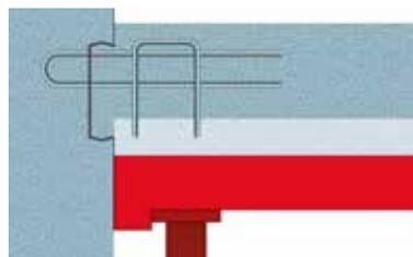
Mettre en place les aciers de ferrailage puis couler la dalle de compression. Le gauffrage à froid et la forme fermée de l'AB-BOX prédalle permettent une bonne reprise du bétonnage avec de la 2<sup>ème</sup> phase de coulage.
