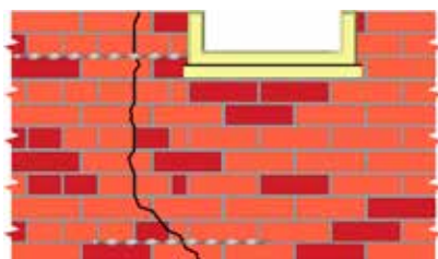
Exemple de réparation de fissures
