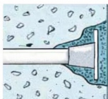
Réhabilitation platine encastrée
