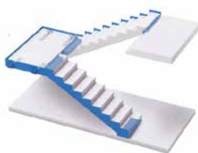
Volée d'escalier droite, palier désolidarisé, palier avec revêtement de sol flottant.
