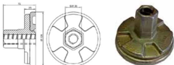
Dimensions des écrous H12
