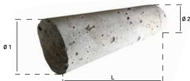
Dimensions des carottes béton CBS
