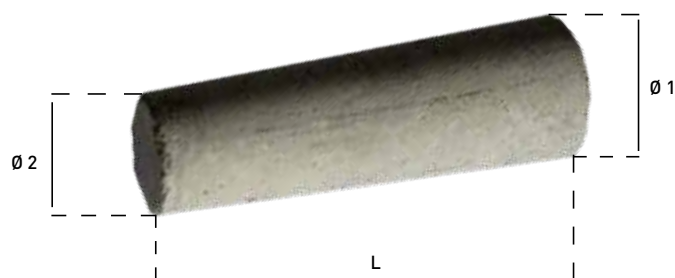
Dimensions des carottes béton Ø 55
