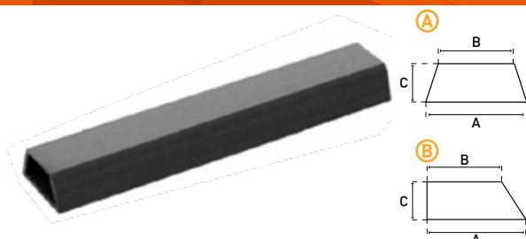
Dimensions des profils trapèzes en PVC
