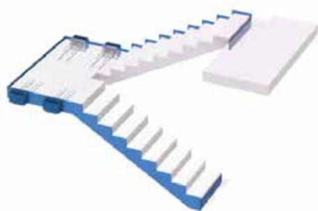
Volée d'escalier droite, palier désolidarisé.
